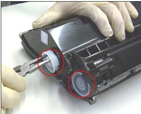
45. Con un par de pinzas de puntas agudas sacar las dos tapas de recarga ubicadas del lado de los engranajes.
