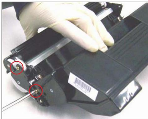
36. Desmontar el lateral del lado engranajes sacando los dos tornillos dorados como se indica.
