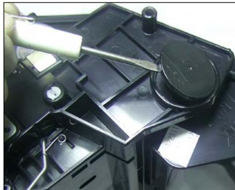
2. Levantar el chip desde el borde o empujarlo desde abajo a través de los orificios.
