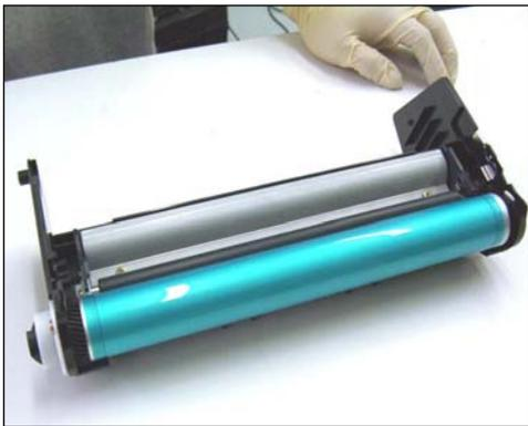
16. Se procede al desmontaje de la unidad de cilindro.
