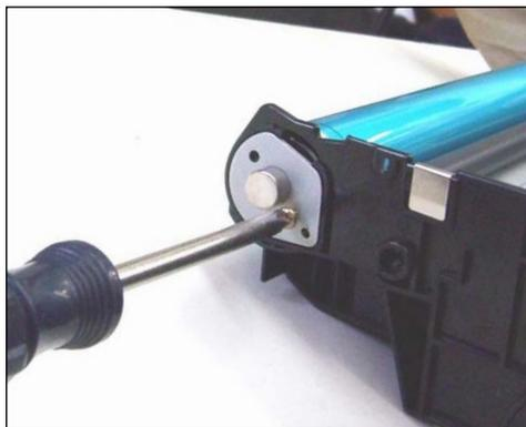
20. esmontar la placa del eje del lado opuesto sacando los dos tornillos que la sujetan.
