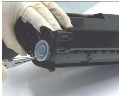
46. Vaciar el tóner remanente, limpiar con aire comprimido o aspiradora antes de separar el depósito.
