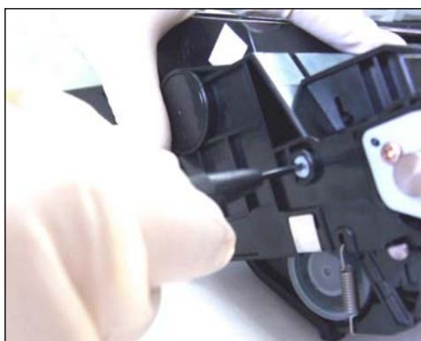
8. Insertar un desarmador plano pequeño de 2,4mm de hoja en el orificio para girar el perno al punto de liberación (girando finamente en sentido contrario al reloj hasta que se siente resistencia).
