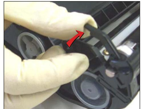
39. Destrabar el Rodillo Magnético levantando la palanca como se indica.
