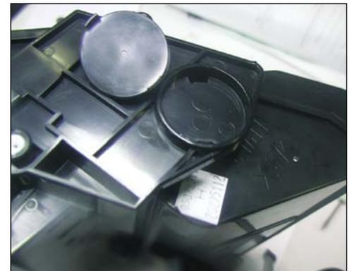
3. La foto muestra el chip ya extraído y la base con los orificios para las lengüetas
