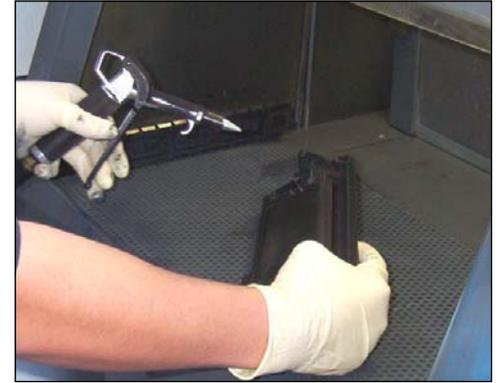
50. Limpiar el conjunto con aire comprimido o aspiradora , recargar con toner y montar el resto del cartucho.
