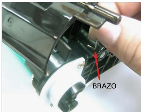
4. Sacar el brazo de la tapa del cilindro de su ranura en el lado de engranajes del cartucho, como se muestra.
