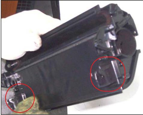
48. El depósito se separa fácilmente mostrando dos sellos de espuma ubicados en la parte inferior.
