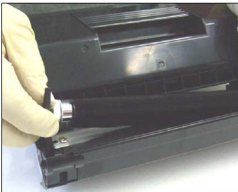
40. Una vez levantada la palanca, levantar el rodillo de ese lado.
